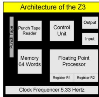
Die **Z3** (<http://www.youtube.com/watch?v=aUXnhVrT4CI>), die auf der Z1 aufbaut, war der erste **funktionsfähige programmgesteuerte Digitalrechner** weltweit und wurde 1941 von Konrad Zuse in Zusammenarbeit mit Helmut Schreyer in Berlin gebaut. Die Z3 besteht aus 600 Relais für das Rechenwerk und 1600 Relais für das Speicherwerk: 64 Gleitkommazahlen werden in je 22 Bit dargestellt. Das Original wurde im Krieg zerstört.
