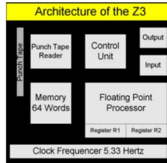
Die **Z3** (<http://www.youtube.com/watch?v=aUXnhVrT4CI>), die auf der Z1 aufbaut, war der erste **funktionsfähige programmgesteuerte Digitalrechner** weltweit und wurde 1941 von Konrad Zuse in Zusammenarbeit mit Helmut Schreyer in Berlin gebaut. Die Z3 besteht aus 600 Relais für das Rechenwerk und 1600 Relais für das Speicherwerk: 64 Gleitkommazahlen werden in je 22 Bit dargestellt. Das Original wurde im Krieg zerstört.
