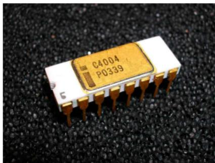
Der Intel 4004 ist ein 4-Bit-Mikroprozessor des Mikrochipherstellers **Intel**, der 1971 auf den Markt kam. Er gilt als der erste Ein-Chip-Mikroprozessor, der in Serie produziert und am freien Markt vertrieben wurde.
