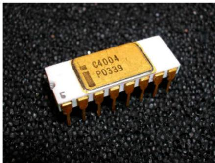
Der Intel 4004 ist ein 4-Bit-Mikroprozessor des Mikrochipherstellers **Intel**, der 1971 auf den Markt kam. Er gilt als der erste Ein-Chip-Mikroprozessor, der in Serie produziert und am freien Markt vertrieben wurde.
