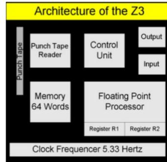
Die **Z3** (<http://www.youtube.com/watch?v=aUXnhVrT4CI>), die auf der Z1 aufbaut, war der erste **funktionsfähige Digitalrechner** weltweit und wurde 1941 von Konrad Zuse in Zusammenarbeit mit Helmut Schreyer in Berlin gebaut. Die Z3 wurde in elektromagnetischer Relais-technik mit 600 Relais für das Rechenwerk und 1600 Relais für das Speicherwerk ausgeführt: 64 Gleitkommazahlen werden in 22 Bit dargestellt. Das Original wurde im Krieg zerstört.
