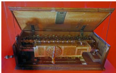
Die *Leibnizsche* Rechenmaschine ist ein Meilenstein. Er erfindet das **Staffelwalzenprinzip** zur schnellen Multiplikation. Sie wird 1673 der Royal Society demonstriert. Allerdings vermutet man, dass es wegen der feinmechanischen Probleme nie eine völlig fehlerfrei arbeitende Maschine gab.
