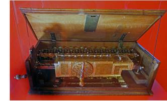
Die **Leibnizsche** Rechenmaschine ist ein Meilenstein. Er erfindet das **Staffelwalzenprinzip** zur schnellen Multiplikation. Sie wird 1673 der Royal Society demonstriert. Allerdings vermutet man, dass es wegen der feinmechanischen Probleme nie eine völlig fehlerfrei arbeitende Maschine gab.
